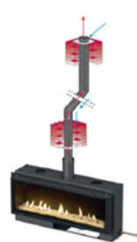
CONEXIÓN EN CHIMENEA PREEXISTENTE
